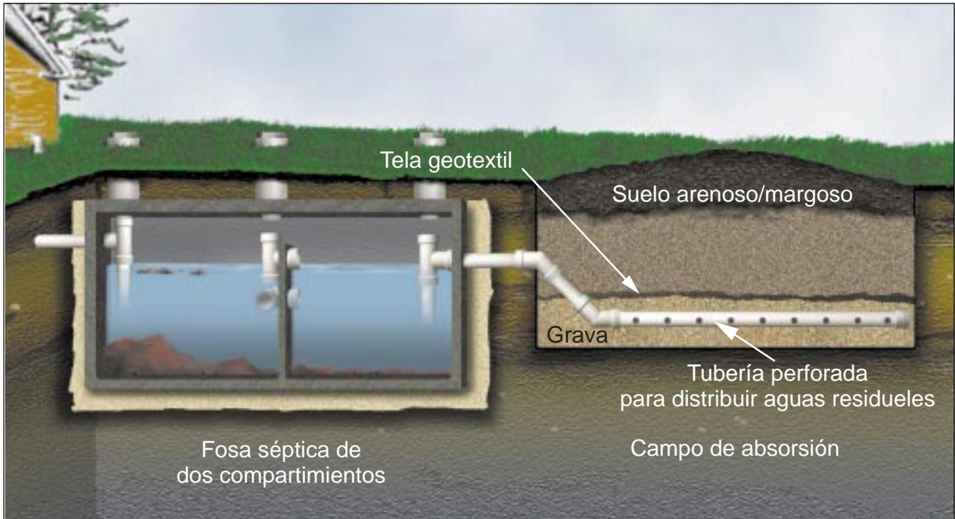
Figura 1: Una fosa séptica y campo de absorción.
